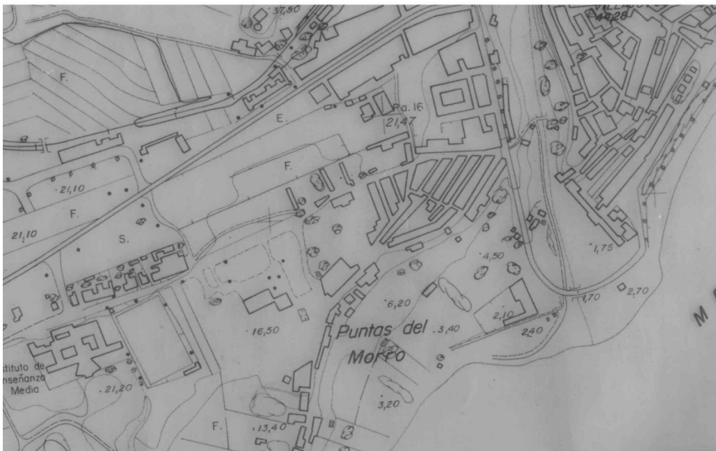
Figura 5: Plano topográfico a partir de vuelo fotogramétrico septiembre 1.976, realizado por TOPYCAR S.L. en proyección U.T.M. elipsoide internacional huso 30 datum postdam, con apoyo de campo.
