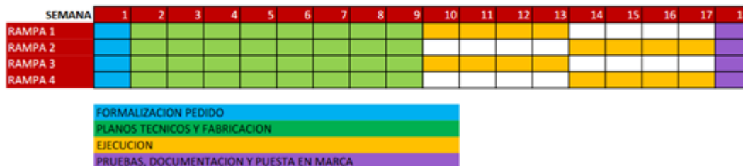
PLANIFICACION EJECUCION MODERNIZACION RAMPAS PARQUE CENSAL - LA VILA JOIOSA
